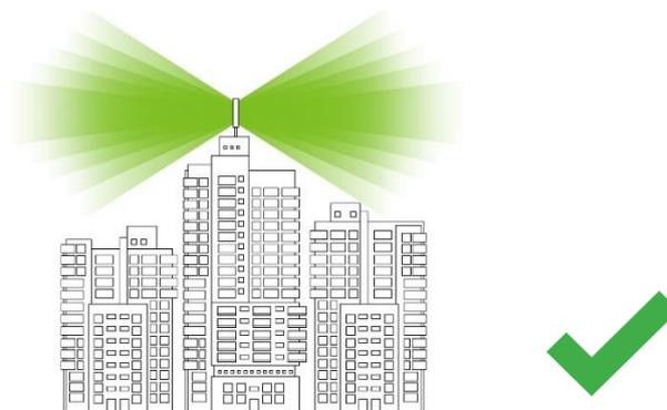
*Рис. А.1 – Схема правильного размещения всенаправленной антенны*
