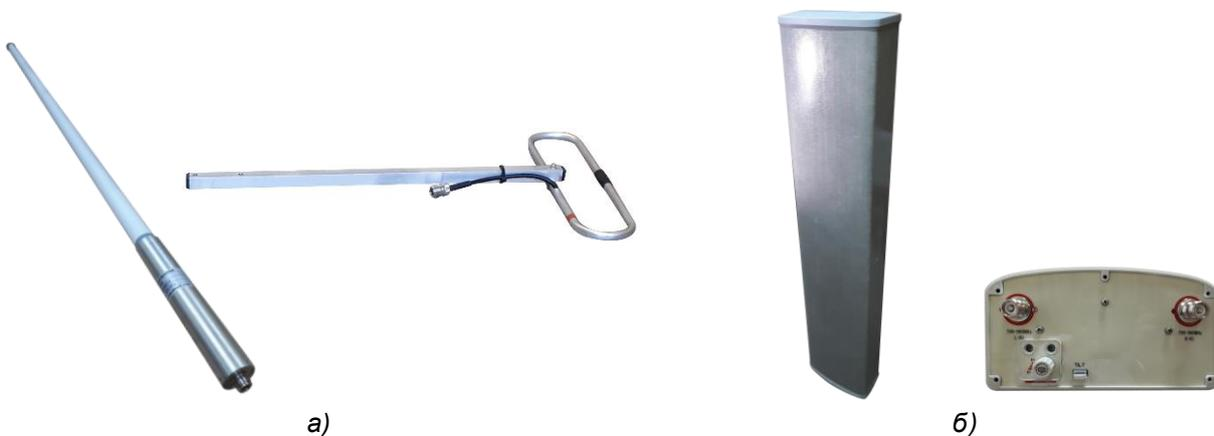
Рис. 3.2 – Внешняя антенна базовой станции
