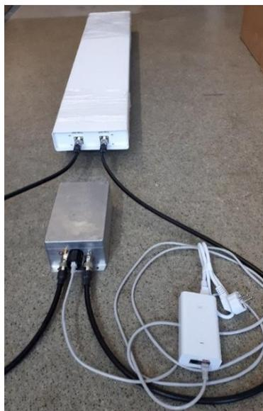
*Рис. 7.3 – Соединение комплектующих базовой станции с секторной антенной*
