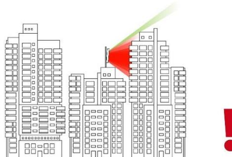
*Рис. А.2.2 – Секторная антенна установлена на здании, окруженном другими более высокими строениями*
