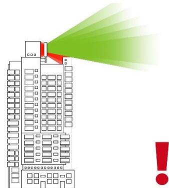
*Рис. А.2.6 – Всенаправленная антенна установлена не на самой высокой части здания. Значительная часть диаграммы закрыта конструкцией здания*
