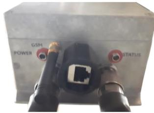
Рис. 7.4 – GSM-антенна на блоке базовой станции
