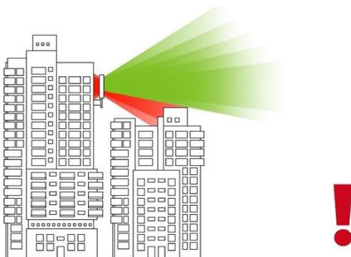
*Рис. А.2.3 – Антенна установлена не на крыше здания, а сбоку*
