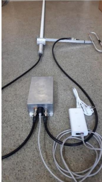
*Рис. 7.2 – Соединение комплектующих базовой станции с всенаправленной антенной*
