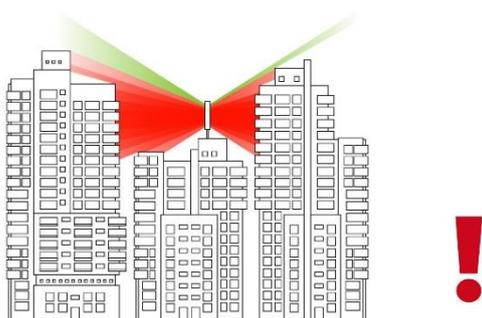
*Рис. А.2.1 – Всенаправленная антенна установлена на здании, окруженном другими более высокими строениями*
