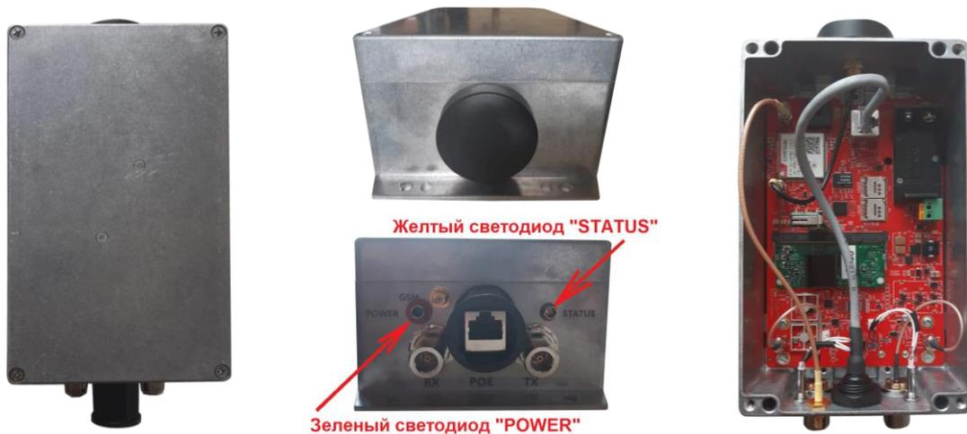
Рис. 3.1 – Приемо-передающий блок базовой станции
