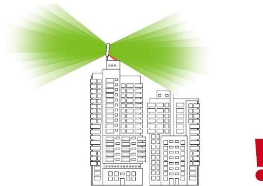
*Рис. А.2.4 – Антенна установлена не вертикально*
